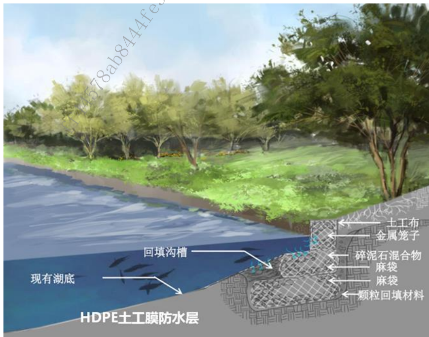
图 4-35 子槽底部防渗做法示意图
